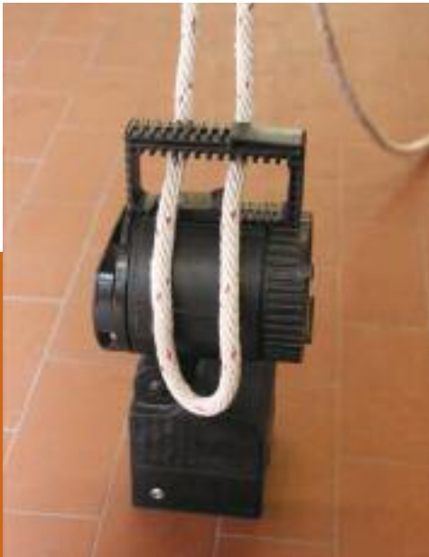
Die Handlampe wird mit einem Doppelten Ankerstich gesichert, um sie hochziehen zu können.
