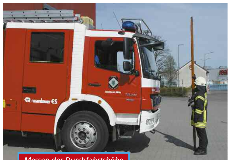
Messen der Durchfahrthöhe
