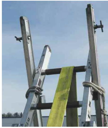
Eigenbau einer Schlauchstütze, zur Vor- nahme von Druckschläuchen, aus zwei Steckleiterteilen und Feuerwehreilen gemäß FwDV 1
