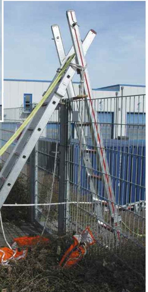
Eigenbau einer Schlauchstütze, zur Vor- nahme von Druckschläuchen, aus zwei Steckleiterteilen und Feuerwehreilen gemäß FwDV 1
