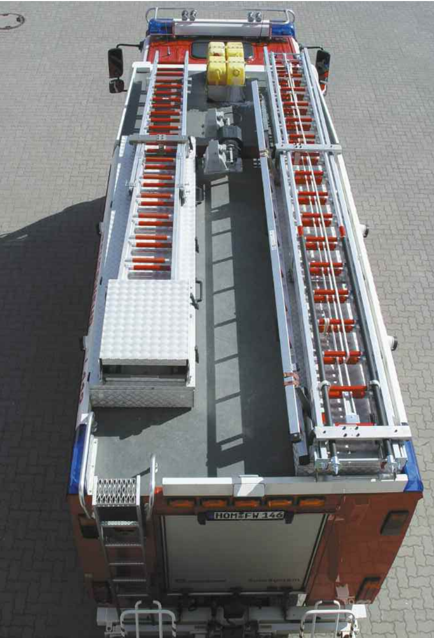
Verladung von Steckleiter, Hakenleiter und Schiebleiter auf einem HLF 20/20.
