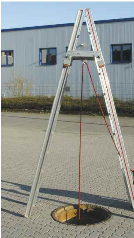
An die Öse am Verbindungsteil können bis zu 150 kg angehängen werden.
